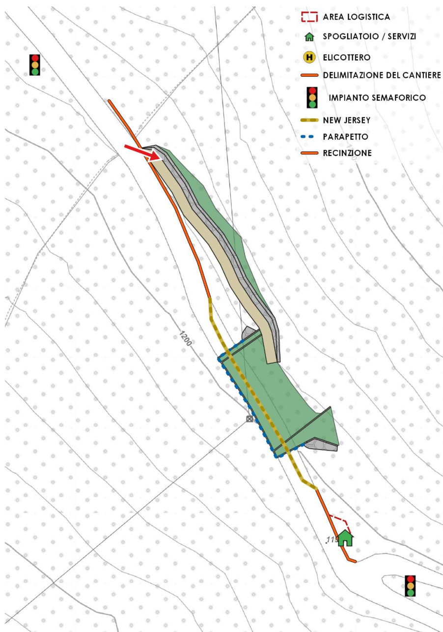
Figura 3.1: layout di cantiere Sito 1
